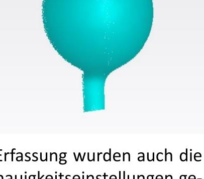
Neben der Präzision bei der Erfassung wurden auch die verschiedenen Filter- und Genauigkeitseinstellungen getestet, welche alle über die Steuerungs- und Verarbeitungssoftware SA ausgewählt werden konnten. Abschließend wurden die Daten mit Sollgeometrien vordefinierter Maße auf Abweichungen verglichen.
