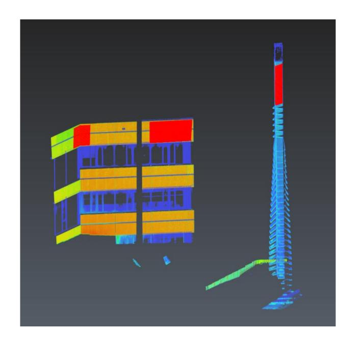
Am extremsten waren die Verformungen wohl an dem gescannten Abschnitt der Stele erkennbar. Es wurden Aufnahmen in stündlichen Abständen mit denen der erstmaligen Messung verglichen.
