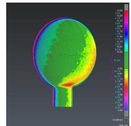
Zu den Auffälligkeiten bei diesen Scans zählte unter anderm ein sich abzeichnender Ring von Störpunkten um die eigentliche Kugelgestalt herum. Ein solcher "Donut" bildete sich ausschließlich, wenn die Kugel freistehend im Raum, ohne einen direkten Hintergrund, abgelichtet wurde. Zur Vorbeugung dieser Störzone wurde ein provisorischer Hintergrund verwendet.
